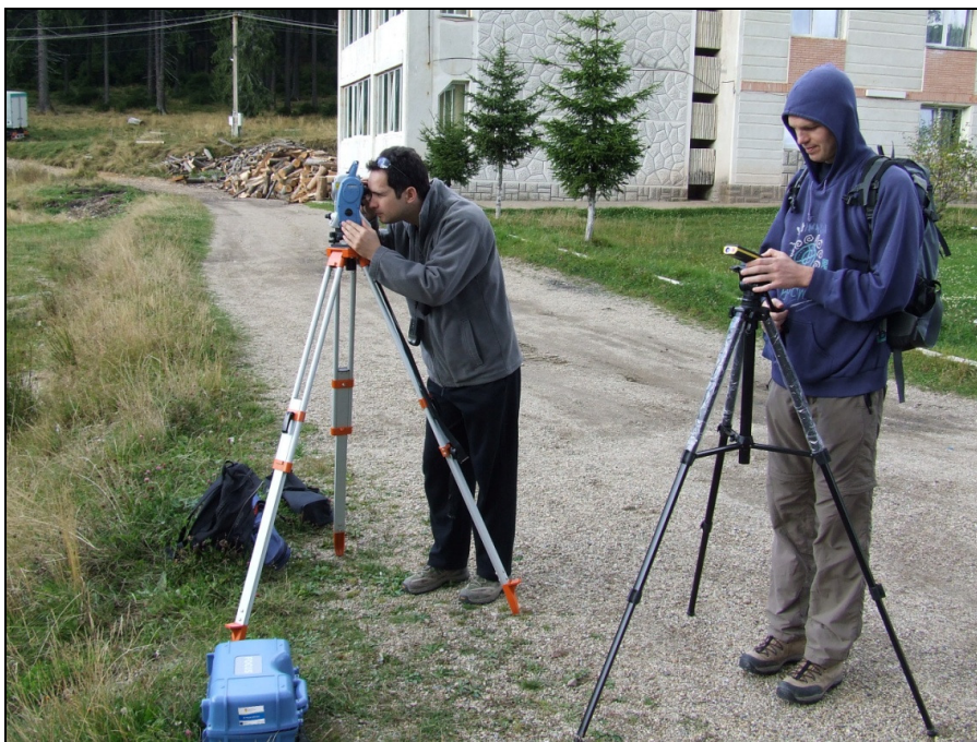
7. ábra. A terepi mérés lézeres mérőállomással, valamint magasságmérővel a biharfüredi mintaterületen.
