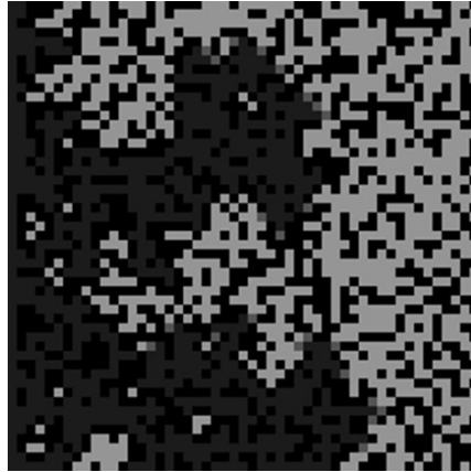
1. ábra Erdőtűz terjedése 50 szimulációs lépés után: A modell feltételezi, hogy nincs szél. A tűz négy irányban terjed: észak, dél, kelet, nyugat. (Wilensky, U., 2006)
