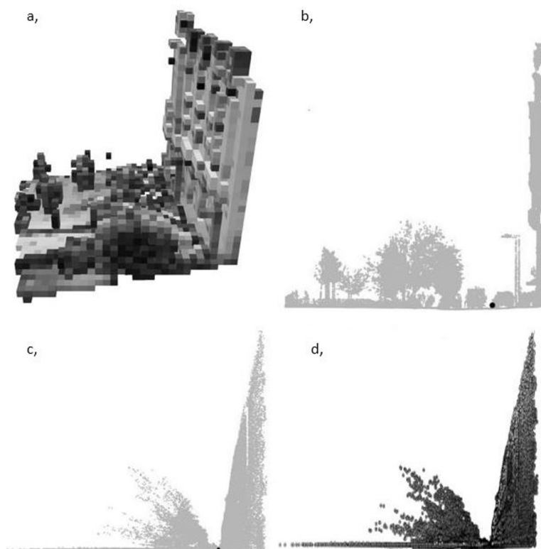
6. ábra a, A helymeghatározáshoz használt mintaterület városmodellje b, A terület oldalnézete az autó (fekete pont) felől c, A vetítés után előállított kép d, A vetítés utáni kép távolság szerint színezve
