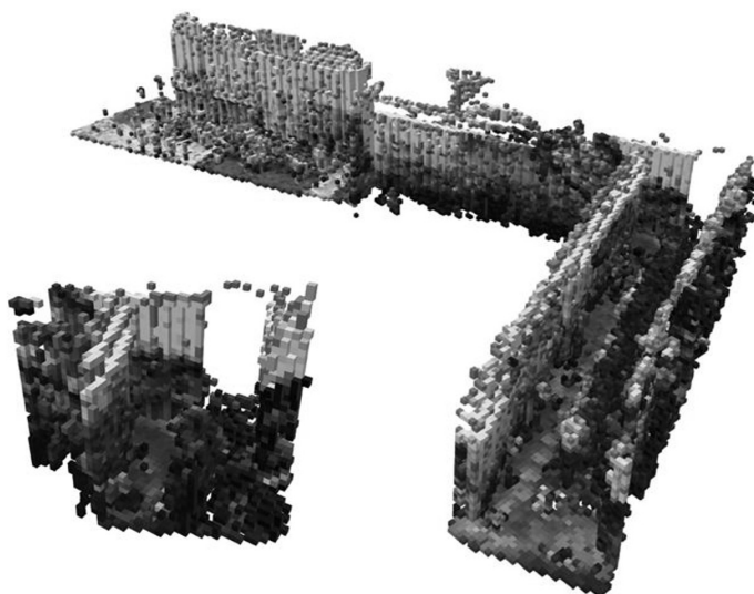
3. ábra MLS mérésekből előállított voxelmodellek
